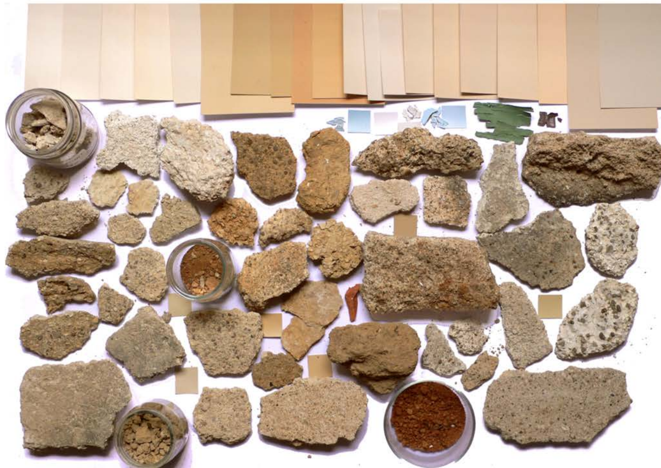
Prélèvements de corps d'enduits, de pierres, sables, tuiles, peintures de portes et volets, effectués en Charente
