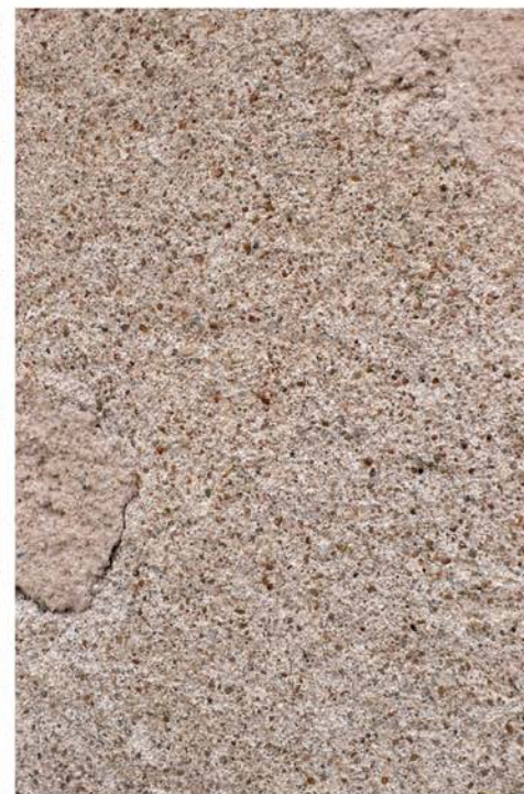
Couleurs des agrégats + Couleur du liant = la teinte globale de l'enduit
